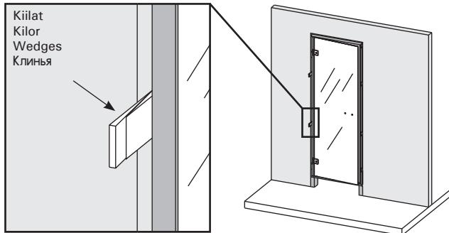
**6.** Kun karmit on kiinnitetty ruuveilla, tarkista vielä että karmit ovat suorassa ja ovi käy hyvin. Tiivistä oven ja seinän väli. Sahaa tarvittaessa kiilat karmiin ylitäväältä osalta (saha pystyasennossa). Poista alatuet ja karmin tukirima. Asenna listat ja kahva.
